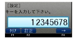
②【DHCP OFF】→IPアドレスを入力し、 実行キー(緑)を押します。 【DHCP ON】→F4 (DHCP) を押します。
